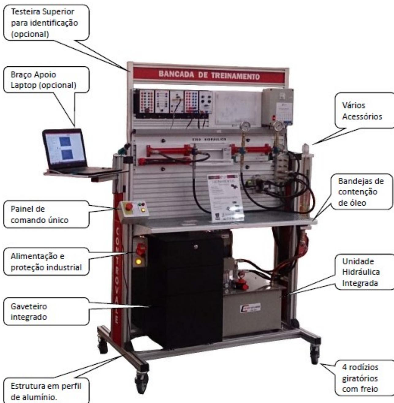
Conjunto mecânico montado em perfil de alumínio estrutural e chapas de aço carbono com acabamento em pintura eletroestática na cor padrão vermelha.
